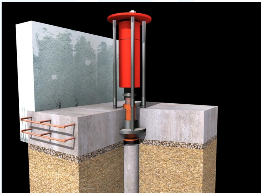
I dispositivi di spinta di un singolo gruppo sono azionati invece in maniera simultanea da una centrale oleodinamica.
